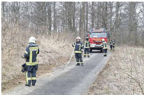
Pump-and-Roll-Prinzip: Entlang der Brandlinie wird Feuer aus der Bewegung heraus gelöscht.
